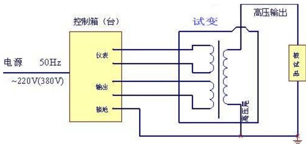
说明：做交流耐压试验时，既可使用 YCD 交流试变，也可使用 YCJ 试变。不过在使用 YCJ 做交流耐压试验时，不必将高压柱上的短路杆拉出来。
